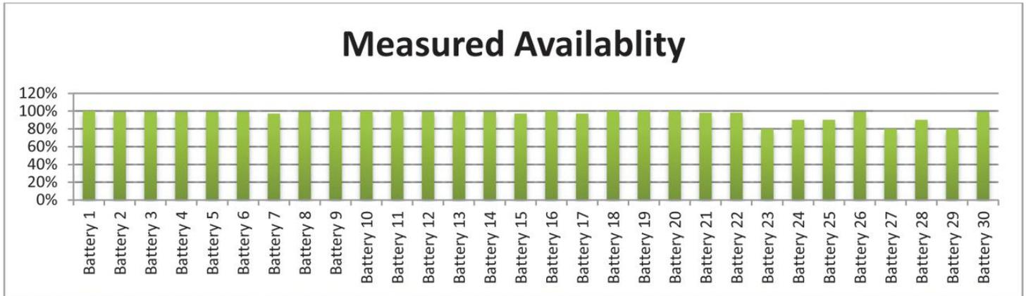
圖-3：電池串的所有個別電池容量(啟用日期/2013-07，使用時數 3 年)
