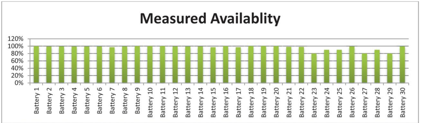
图-3：电池串的所有个别电池容量(启用日期/2013-07，使用时数 3 年)
