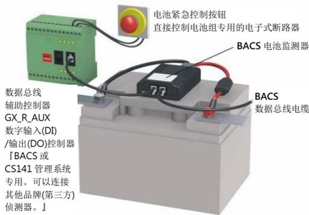
BACS 系统能够透过监测每颗电池/每单颗电池的温度和(可选)的电池组(串)电流来检测出热失控的风险。如果热失控被检测到, BACS 系统会将电池组(串)的电子断路器自动触发跳脱, 从而断开及隔离电池组(串)。这个原则是符合 2018 国际消防法规 —— International Fire Code (IFC) —— 第 1206.2.10.7 章节的规范, 并且在美国这个国家对于电池的安装是强制性必须符合这个规范。
