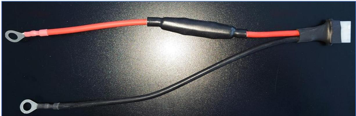
这张相片是 BACS 系统典型的 BC5 无卤素 (Halogen Free) 电池量测线，可以明显看到 1,000V 的气密式密封型高压保险丝，气密式密封型可以防止电池于充电过程中所泄出的氢气被点燃。
